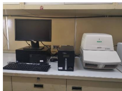
เครื่อง Real time PCR สามารถเพิ่มปริมาณ ดีเอ็นเอที่ต้องการได้พร้อมแสดงผล ภาพบนหน้าจอของตัวอย่างได้ทันที
